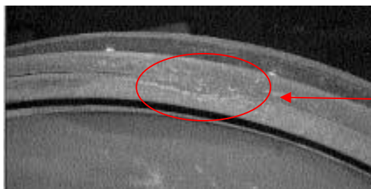
Fig. 8 Surface de contact irrégulière sur le pourtour de la jante-bandage
