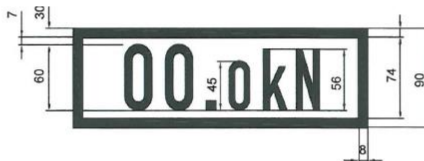
Figure 4 : Inscription de l'effort de retenue en kN pour véhicules munis d'un frein à vis
