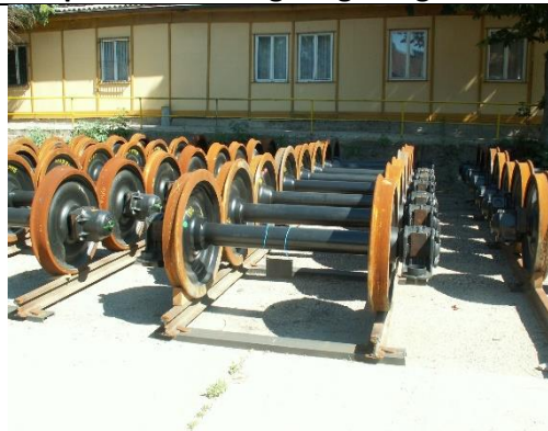
Bild 1: Lagerung im Gleis mittels Sicherungskeilen
