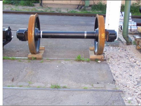
Bild 6: Einzellagerung mittels Ladegestell für Einzelradsätze
