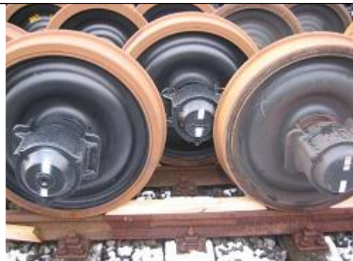
Bild 3: Versetzte Lagerung im Gleis (Doppelschiene)
