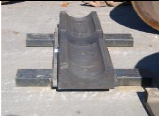
Bild 5: Radsatzaufnahme für Gabelstapler
