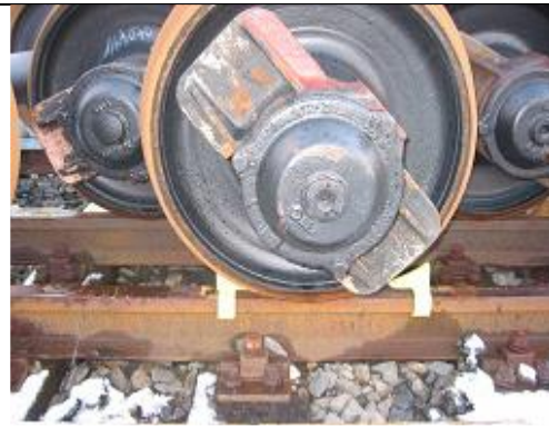
Bild 2: versetzte Lagerung im Gleis mittels Sicherungskeilen
