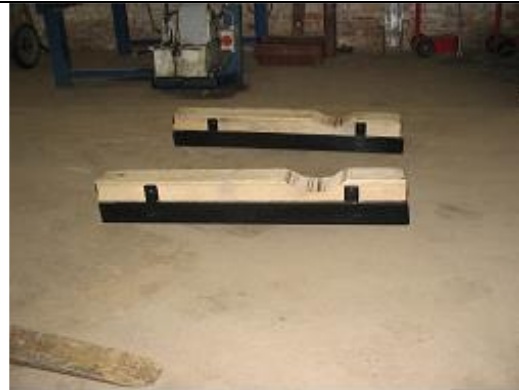
Bild 6: Radsatzaufnahme für Gabelstapler
