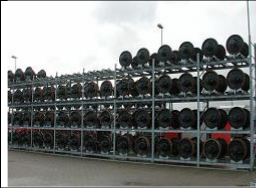
Bild 5: Gestapelte Lagerung mittels Ladegestell
