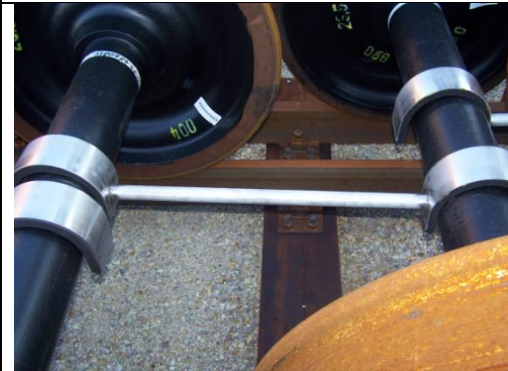
Bild 7: Versetzte Lagerung im Doppelgleis mittels Abstandhaltern
