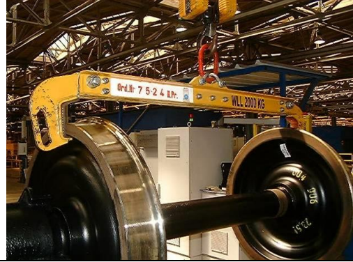
Bild 4: Radsatzaufnahme für Gabelstapler
