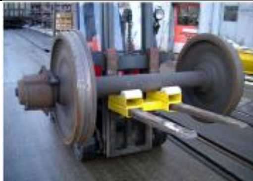
Bild 7: Radsatzaufnahme für Gabelstapler (geladen)
