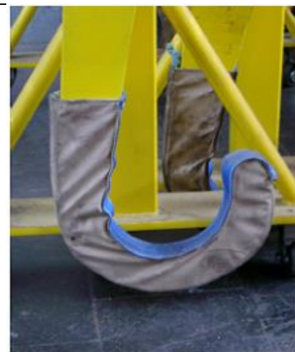
Bild 2: Kranhebegestell für Radsätze, Schutz abnehmbar
